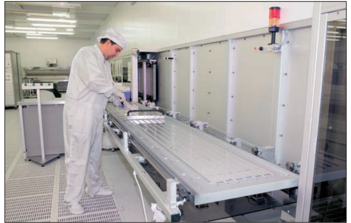
Vakuumanlage zum Aufbringen von Chromschichten
