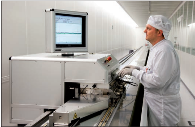
30 m lange Messmaschine für Maßbänder
