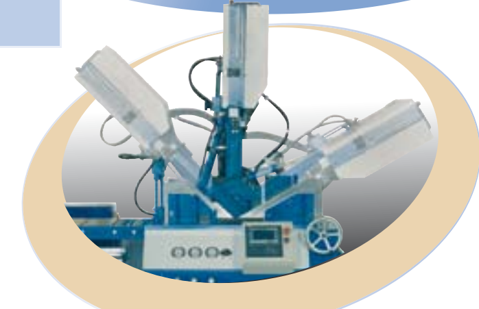
Classic 520 DGH halbautomatische Vertikal Bandsäge für beidseitige Gehrungsschnitte, Sägevorschub und Materialspannung hydraulisch, Winkel \pm 45^\circ , -30^\circ (60°)
