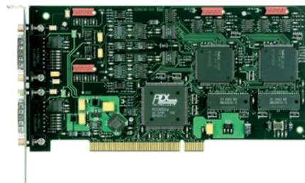
Der Signalkonverter IK 220 ist eine Auswertelektronik für zwei Achsen. In Ausführung einer PC-Zählerkarte kann der IK 220 direkt in einen freien PCI-Steckplatz des Computers gesteckt werden.
