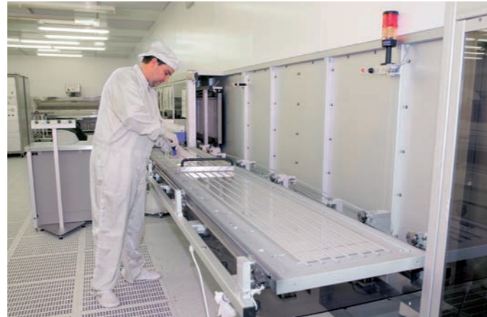
Vakuumanlage zum Aufbringen von Chromschichten
