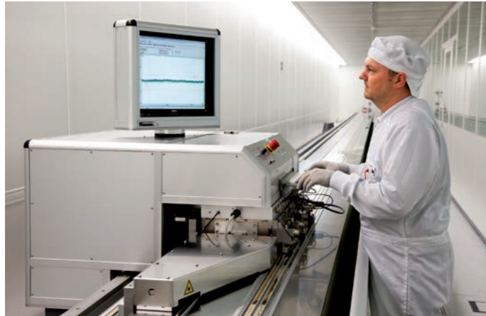
30 m lange Messmaschine für Maßbänder
