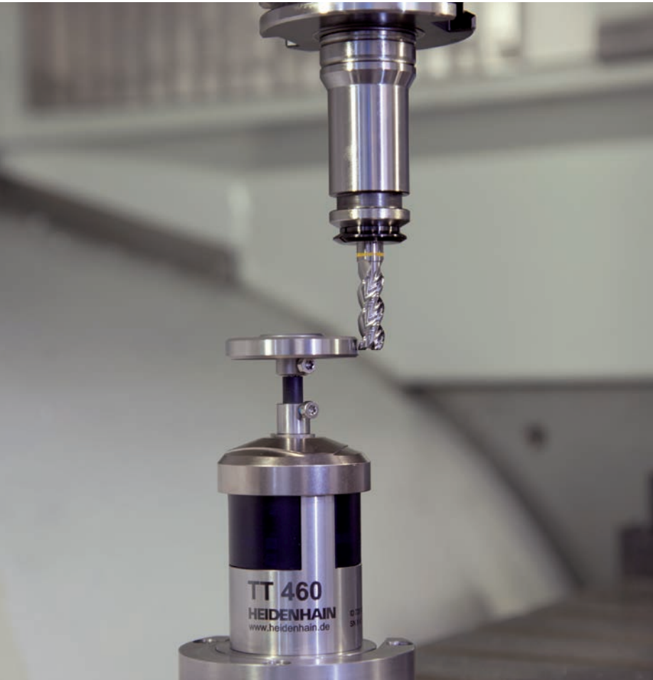
Einzelschneiden vermessen, z. B. zur Überprüfung von Wende-Schneidplatten (nicht für bruchempfindliche Schneiden)
