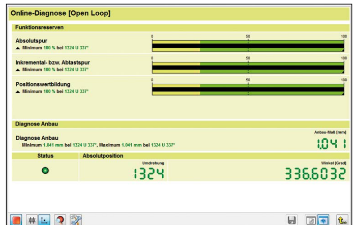
Diagnose über PWM 20 und ATS-Software
